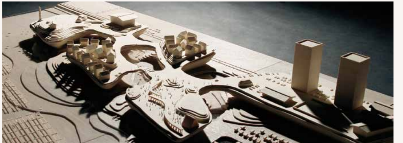
模型写真：ユニークな人工地盤は、津波の破壊力に耐える6つのオワン形状が連結したものです。
