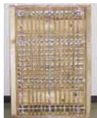
実験用に制作した小舞壁
