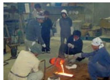
鍍金工房にて熔解した金属を型に流し込む↑
