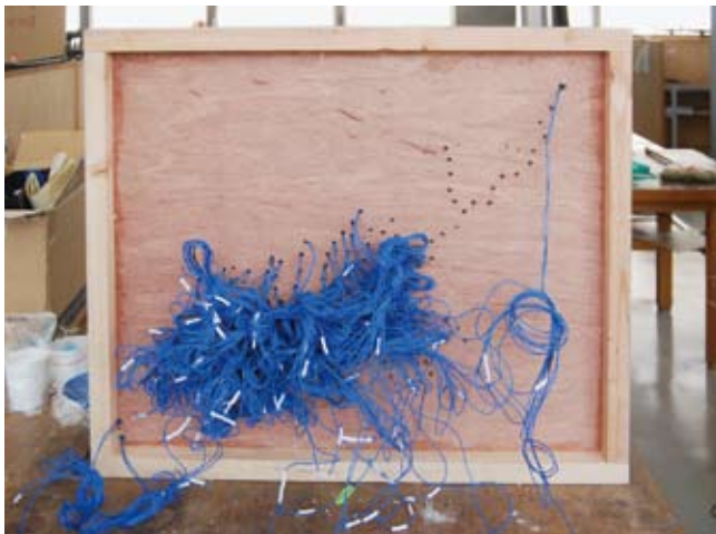
写真3-3 管轄地域上流側模型 電飾装着（裏）
