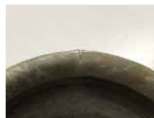
成形中の破断箇所
