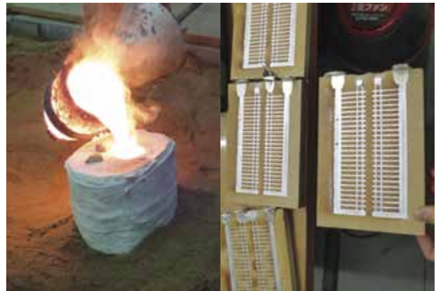
鋳造状況(左:銘板鋳造時 右:柵状アクリル板囲鋳造後)
