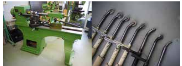
成形加工に使用したヘラ絞り機 (スピニングレース)・ヘラ各種
