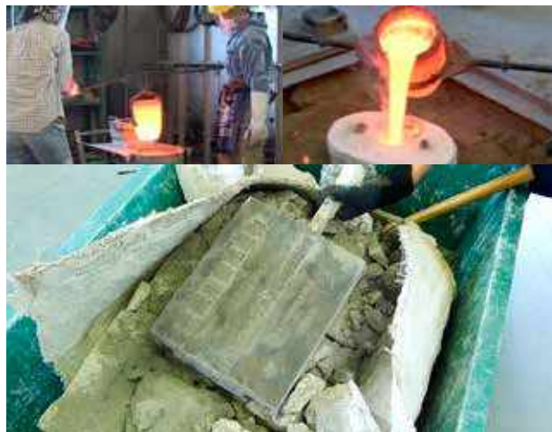
制作(6)(7) 鋳造作業および型開け状況
