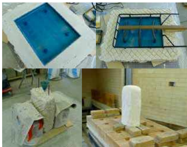
制作(4)(5) 鑄型制作および窯入れの状況
