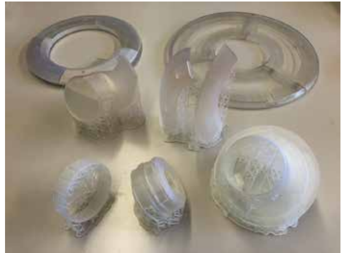
図5 3D プリンティングで出力されたベース部部品
