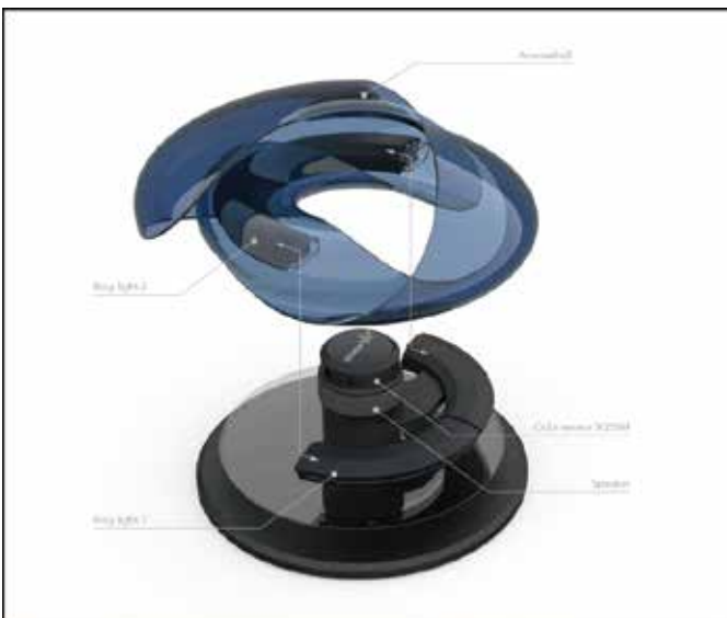
図4 Aromashellとリングライトが鎖状につながる構造
