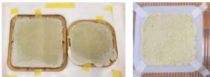
木製の枠を用いると外側の水分が木枠に吸われる
