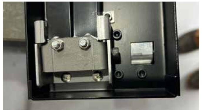
図12：左右脚部開閉/固定機構
