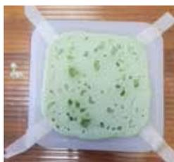
CMC が十分に溶けていない状態で制作した器（乾燥後）
