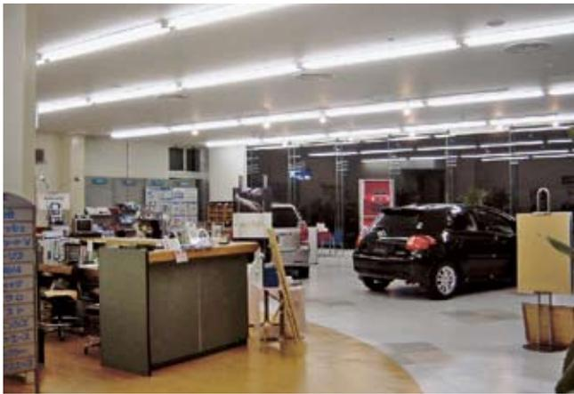
配線ダクトの照明器具の方向が悪く、ほとんど全ての器具が入口方向を向いているので、照明したい部分を決め、集中的に照明するように提案した。また、テーブルとテーブルの間の仕切りがなく、落ち着いた感じにするため、プランターの設置を提案した。
