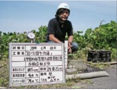
基礎コンクリート打設前のスランプほかの確認
