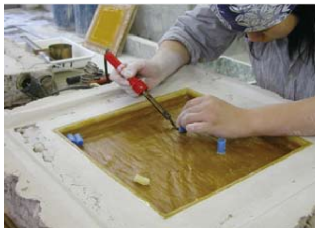
湯道の取付状況
