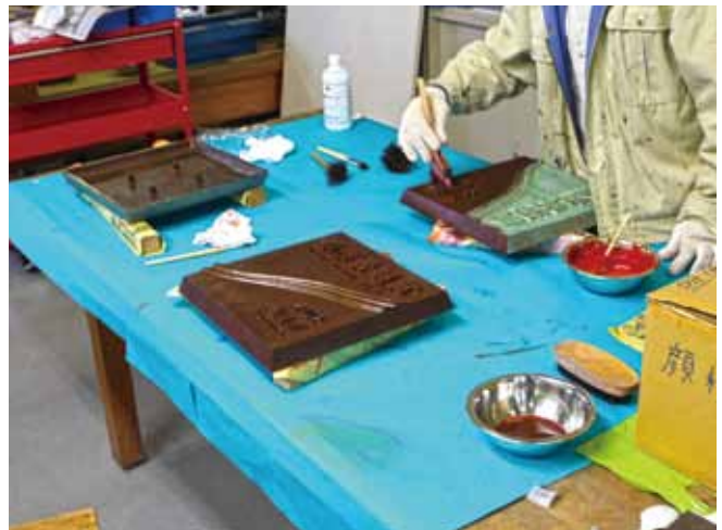
銘板の仕上げ後、緑青を人為的に生成し、調色した顔料を塗布する。
