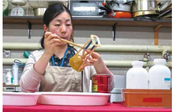
トロフィーと石製台座との接続部分の蠟原型制作状況
