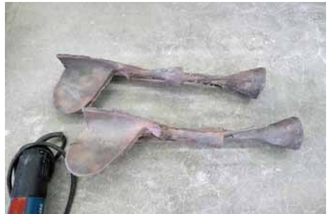
casting 後、酸化皮膜をサンドブラストで除去した状況
