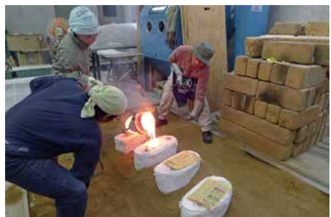
銘板の鋳造状況。地金の鋳造温度は約 1100°C である。
