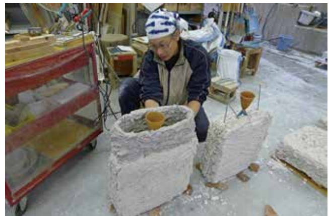
鋳型制作状況。湯口部分を埋没剤で盛り付けている。
