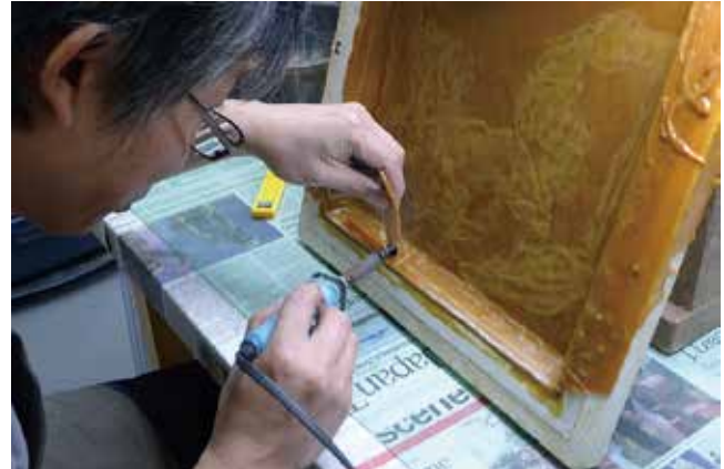
銘板の蠟原型制作状況。縁部分に厚みを付けている。
